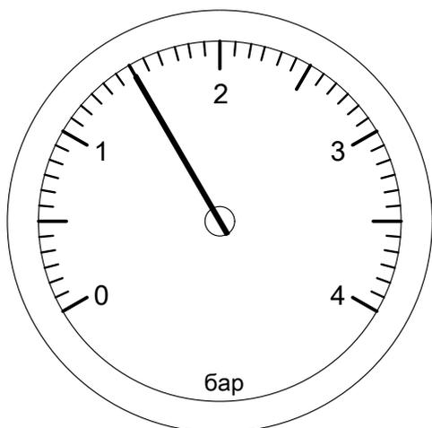
1. Проверить давление отопительной установки по манометру.
