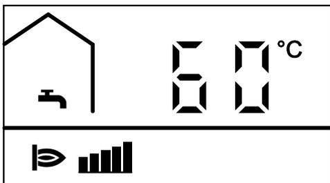
Температура котловой воды постоянно отображается на дисплее во время работы.
