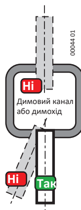
Ф.10 - Вхід випускної труби в димохід/димову трубу
